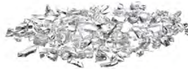
強化玻璃破裂之呈現碎片
