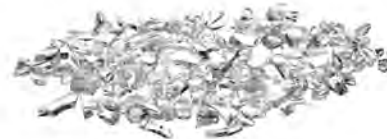
強化玻璃破裂之呈現碎片
